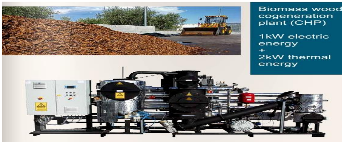
Εικόνα 3.2.2: Παράδειγμα μικρής μονάδας βιοαερίου με αεριοποίηση [9].
