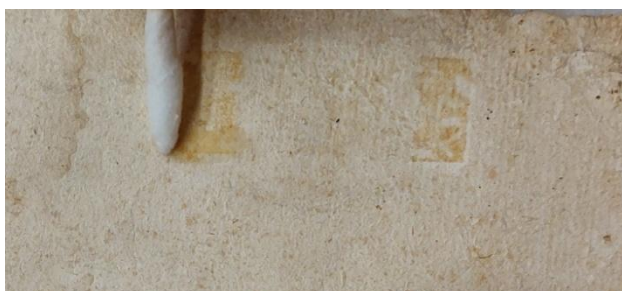
Εικόνα 59. Κατά την διαδικασία αφαίρεσης επικάλυψης από ταινία με πετρελαϊκό αιθέρα (BXM 18786). Λήψη Θεοδώρου Νικολέτα (2024)
