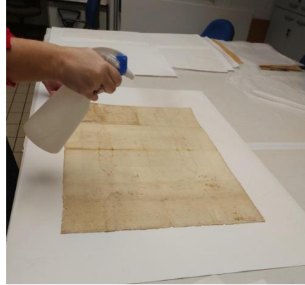
Εικόνα 61. Κατά την διαδικασία υγρού καθαρισμού με ψεκάσμο (BXM 18786), Λήψη Θεοδώρου Νικολέτα (2024)
