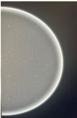
Εικόνα 49 : 2D απεικόνιση του CIRS 3D ομοιώματος χρησιμοποιώντας την πλάκα 3 (γεωμετρική ακρίβεια).
