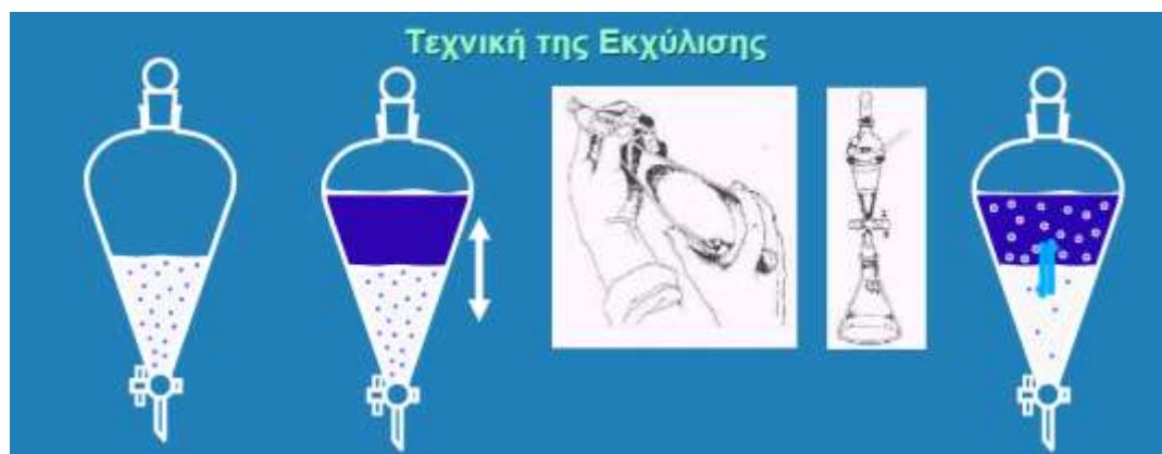
Εικόνα 15: Εκχύλιση υγρού ή στερεού σώματος διαλυμένου σε υγρό (διαλύτης Α) από άλλο υγρό (εκχύλισης διαλύτης Β) (liquid – liquid extraction).
