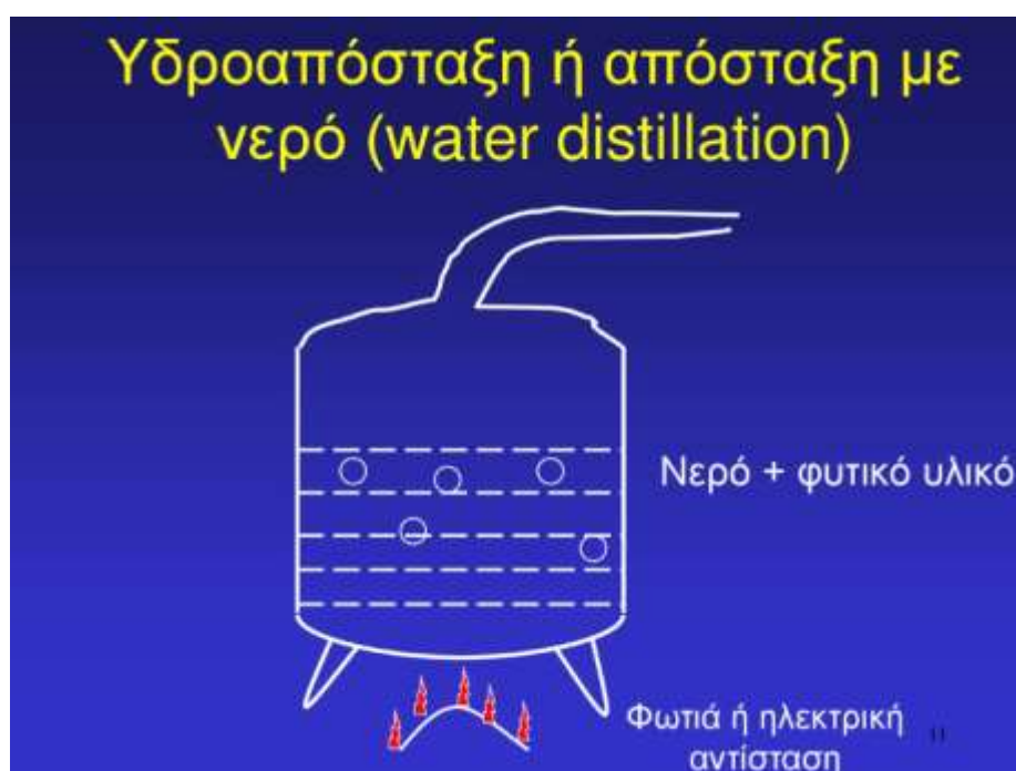
Εικόνα 12: Υδροαπόσταξη ή απόσταξη με νερό (Πηγή : slideplayer.gr )
