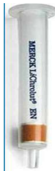
Εικόνα 17: Εκχύλιση στερεής φάσης
