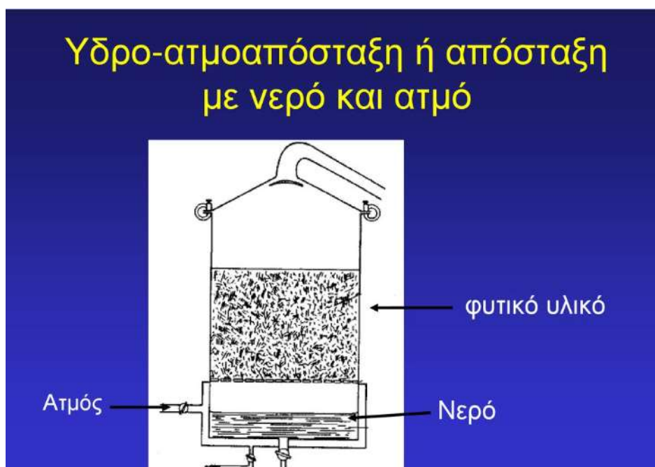
Εικόνα 13: Υδρο-ατμοαπόσταξη ή απόσταξη με νερό και ατμό
