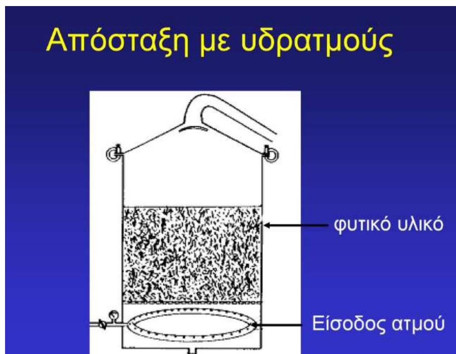
Εικόνα 14: Απόσταξη με υδρατμούς (Πηγή : slideplayer.gr )
