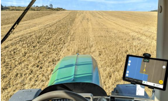
Εικόνα 4 Πλοήγηση τρακτέρ με τη χρήση controller
