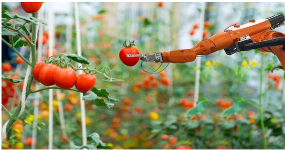
Εικόνα 5 Ρομπότ περισυλλογής καρπών και φρούτων
