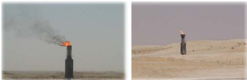
Εικόνα 11: Απεικόνιση της φλόγας πριν και μετά την εφαρμογή του HPAAS (Smith S. , 2012)
