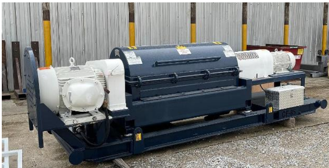
Εικόνα 15: Σχηματική απεικόνιση tricanter (IFM, 2020)
