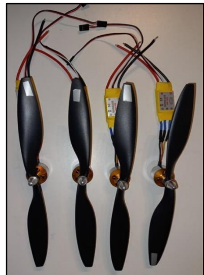
Εικόνα 80. Τα 4 τέσσερα μοτέρ με τις προπέλες τους και τα ESC's
