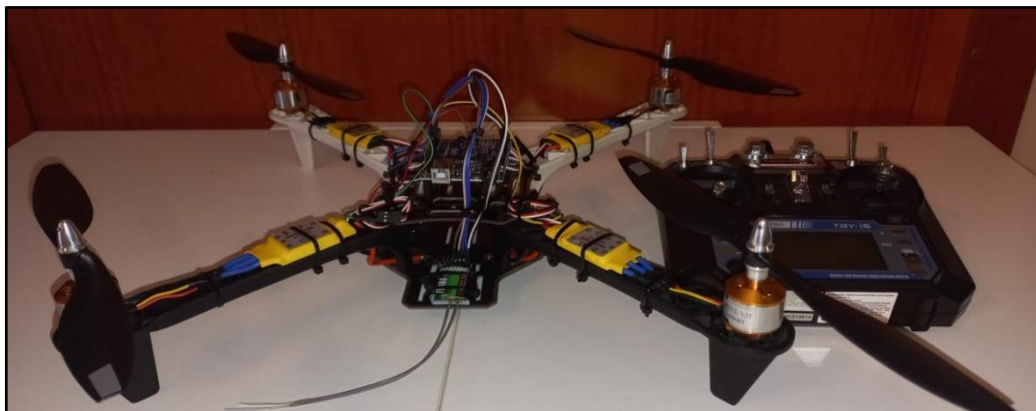
Εικόνα 92. Εικόνες από την συναρμολόγηση της πρώτης έκδοσης του τετρακόπτερου
