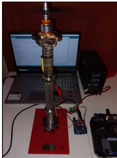
Εικόνα 79. Το setup του πειράματος Τροφοδοτικό, ζυγαριά, υπολογιστής, τηλεχειρισμός και η κατασκευή του μοτέρ με το ESC και τις συνδέσεις.
