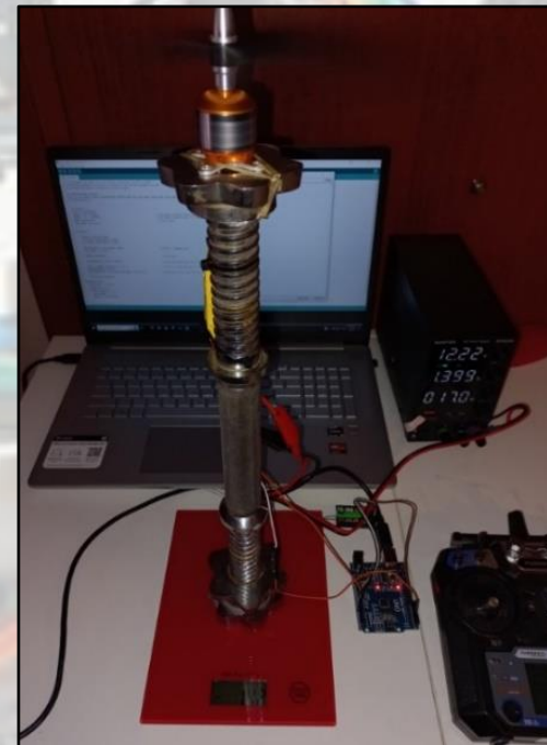
Τροφοδοτικό, ζυγαριά, υπολογιστής, τηλεχειρισμός και η κατασκευή του μοτέρ με το ESC και τις συνδέσεις.
