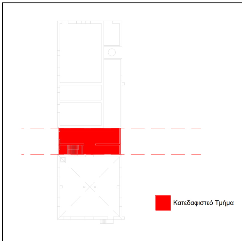
Εικόνα 7.3: Κατεδαφιστέο τμήμα κτιριακού όγκου (Ιδία επεξεργασία, 2023)
