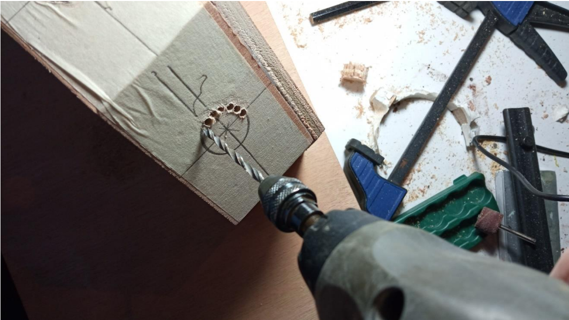
Εικόνα 69 - Διάνοιξη οπών για τους αισθητήρες
