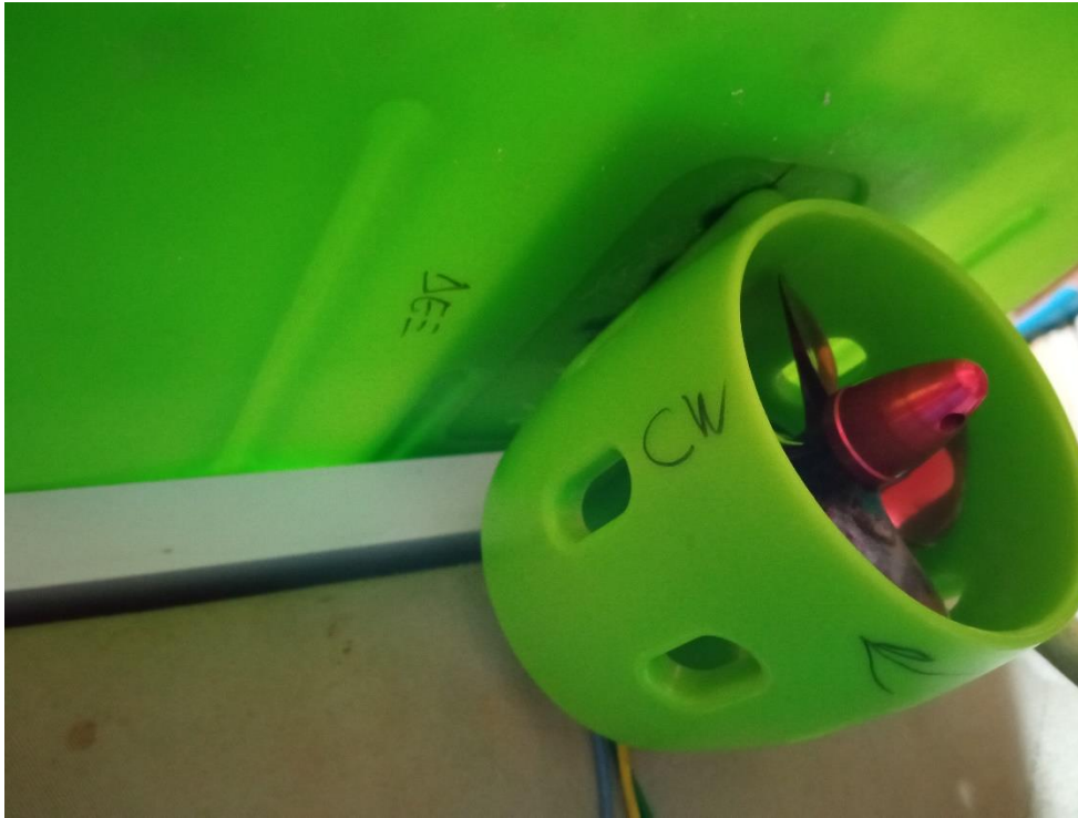
Εικόνα 30 - Τοποθέτηση των προωθητήρων
