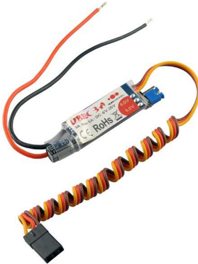
Εικόνα 63 - Το BEC που χρησιμοποιήθηκε. Πηγή: https://www.diamond-models.gr/images/detailed/29/UBEC-3A-4100503_b_0139910216553649ad5ec6f7.jpg
