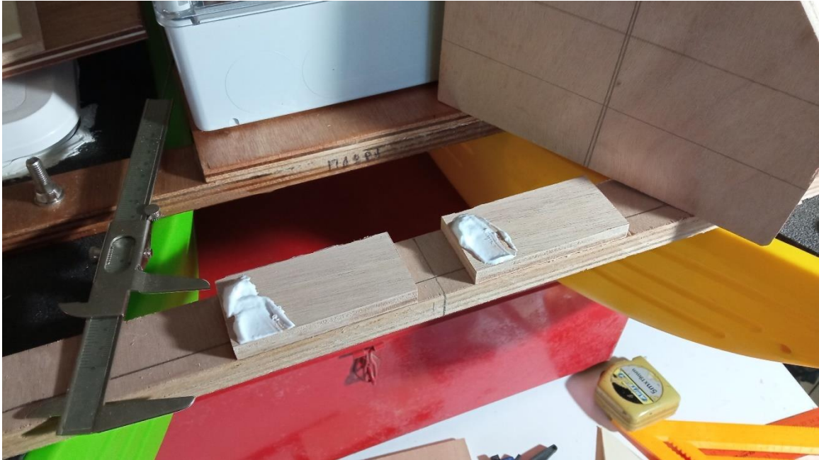
Εικόνα 73 - Τα πλακίδια υπερίψωσης με την ζυλόκολλα πριν να στρωθεί
