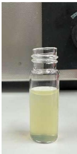
Εικόνα 23: Τελική μορφή διαλυτοποίησης συμπλόκου Ni(PDC)_2 με προσθήκη DMSO
