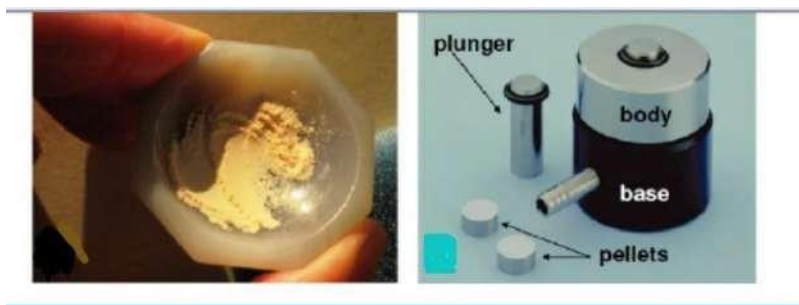
Εικόνα 33: (αριστερά) ιγδίο από αχάτη όπου λειοτριβούνται τα υλικά, (δεξιά) ειδική συσκευή συμπίεσης (μήτρα)
