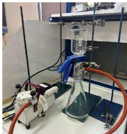
Εικόνα 21: (αριστερά) Σχηματική απεικόνιση διάταξης διήθησης υπό κενό, (δεξιά) εργαστηριακή διάταξη διήθησης υπόκενό.
