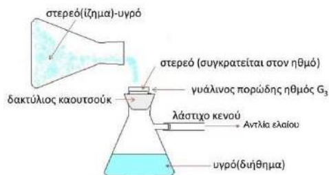
Εικόνα 21: (αριστερά) Σχηματική απεικόνιση διάταξης διήθησης υπό κενό, (δεξιά) εργαστηριακή διάταξη διήθησης υπόκενό.
