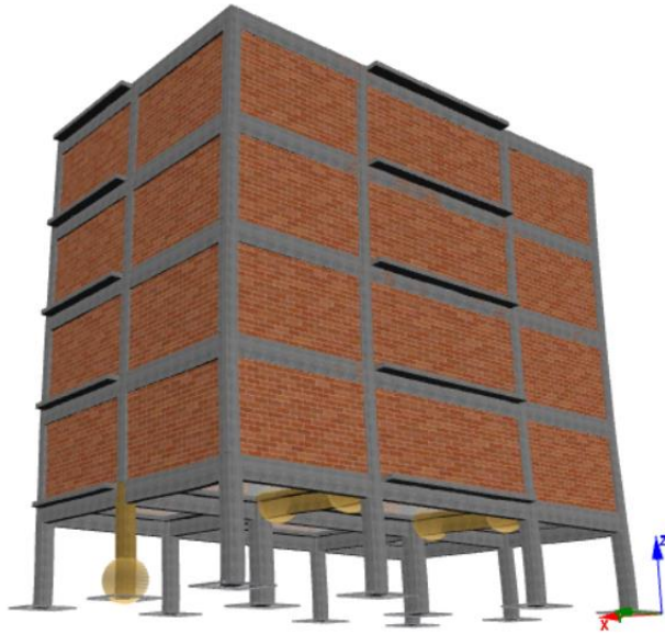
Σχήμα 4.38: Βλάβες στο κτίριο για σεισμική επιτάχυνση 0,134g και 10% διάβρωση του οπλισμού του
