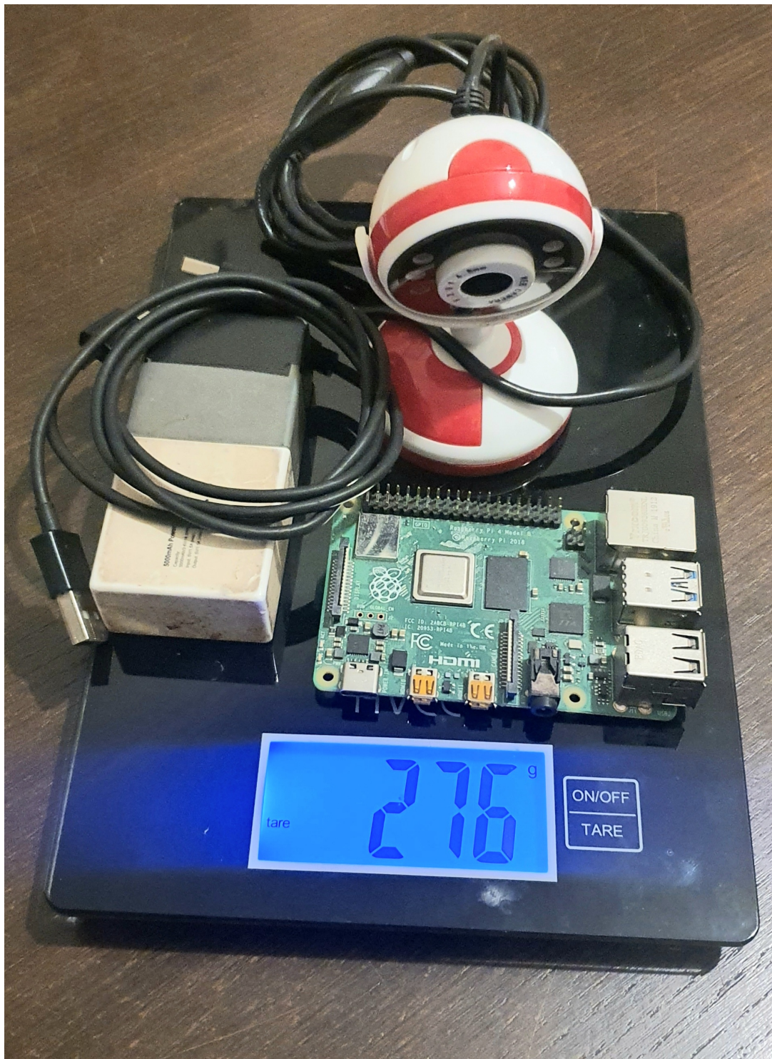
Εικόνα 7.6 Ζύγιση κατασκευής client
