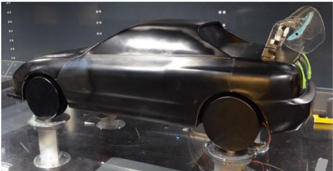
Σχήμα 3-11 Στιγμιότυπο του πειραματικού οχήματος κλίμακας 1:2.5 μέσα στην αεροσήραγγα (Kurec, Remer, Mayer, et al., 2019)
