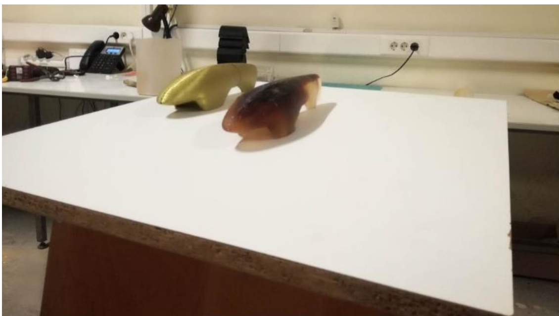
Σχήμα 5-14 Απεικόνιση του τελικού μοντέλου ρητίνης (δεξιά) και του αρχικού 3D printed μοντέλου (αριστερά), εδρασμένα στην κατεργασμένη πλάκα
