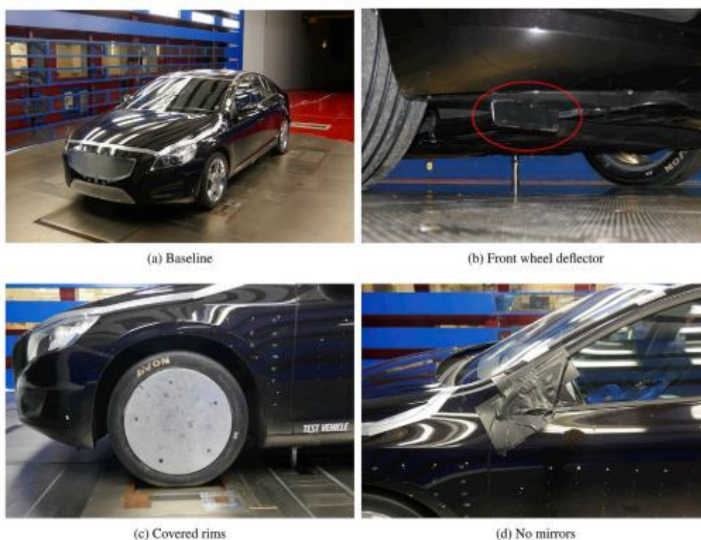
Σχήμα 3-32 Πειραματική διάταξη στην αεροσήραγγα της Volvo (Ljungskog et al., 2020)
