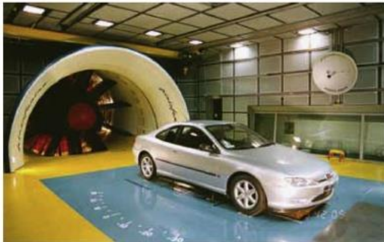
Σχήμα 3-7 Εγκατάσταση αεροδυναμικής σήραγγας (Cogotti, 2008)
