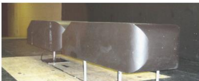
Σχήμα 3-17 Πειραματική διάταξη με τα υπό μελέτη Ahmed models (Watkins & Vano, 2008)
