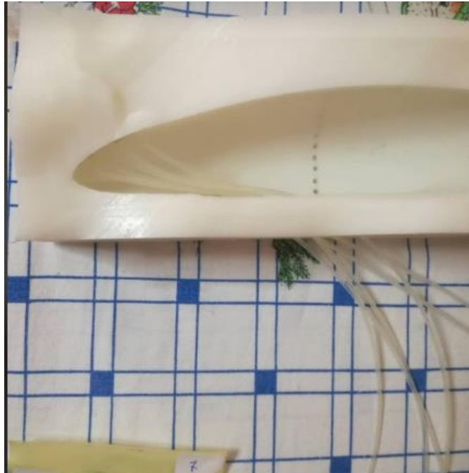
Σχήμα 5-9 Τοποθέτηση σωλήνων στις οπές του καλούπιού
