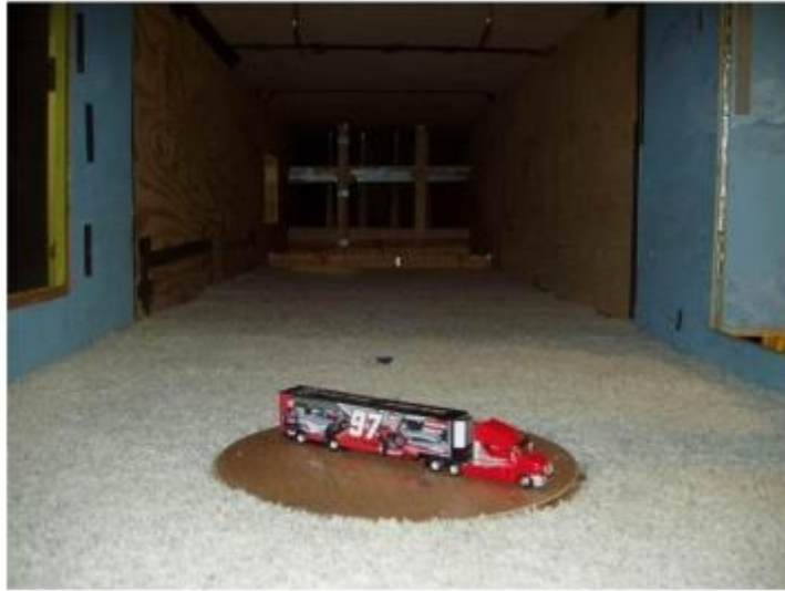
Σχήμα 3-24 Δοκιμή υπό κλίμακα οχήματος σε ροή οριακού στρώματος (Liu et al., 2016)
