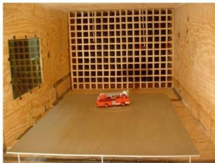
Σχήμα 3-23 Δοκιμή υπό κλίμακα οχήματος σε τυρβώδη ροή (Liu et al., 2016)
