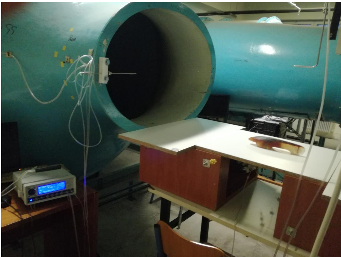
Σχήμα 6-2 Απεικόνιση του μοντέλου στην αεροσήραγγα τύπου Göttingen με ανοιχτό θάλαμο δοκιμών (Σύνδεση σωληνίσκων μέσω οπών)
