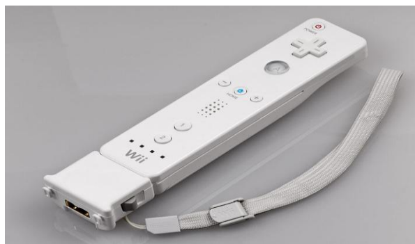
Εικόνα 11. Συσκευή Wiimote με το πρόσθετο γυροσκόπιο MotionPlus
