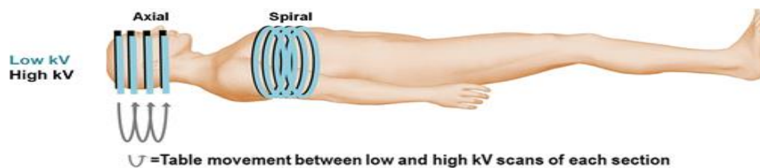
Εικόνα 5: Αναπαράσταση Axial και Spiral CT Πηγή : Radiology, Vol 273, No 3-24/08/2015
