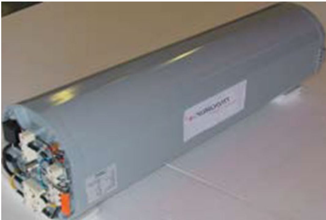
Εικόνα 4.3 : Πρωτεύων συσσωρευτής αργύρου-ψευδαργύρου SLST-C1 [90].
