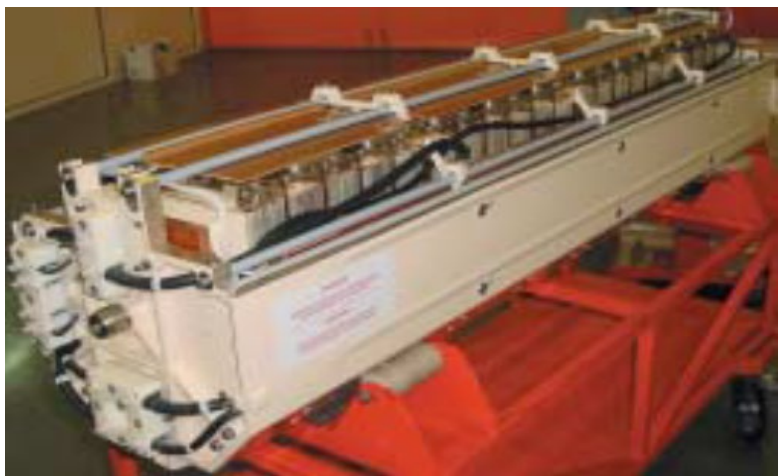
Εικόνα 4.5 : Δευτερεύων συσσωρευτής αργύρου-ψευδαργύρου SLST-E1 [90].
