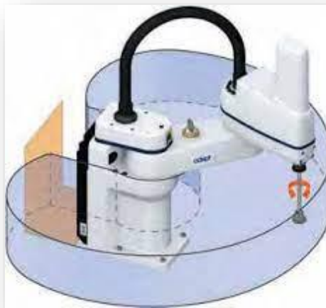
Εικόνα 1.2.4: Χώρος εργασίας ρομποτικού συστήματος SCARA.
