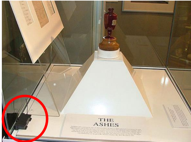
Εικόνα 163. Ανιχνευτής κίνησης μέσα σε προθήκη.
