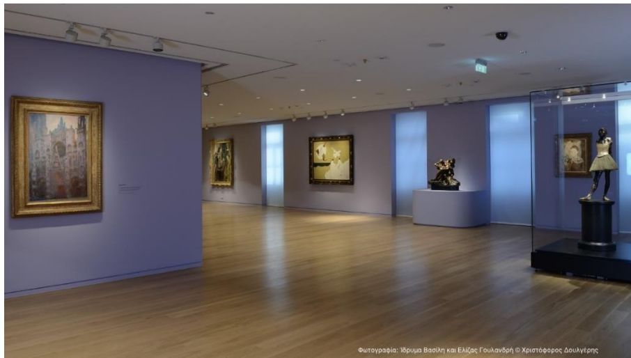
Εικόνα 210. Τεχνητός φωτισμός από την οροφή αίθουσας με την τεχνική small και middle angle , τεχνητός φωτισμός αντικειμένων και πινάκων πιθανώς με φωτισμό LED και μερικώς φυσικός φωτισμός από τα παράθυρα σε αίθουσα του Μουσείου Σύγχρονης Τέχνης του Ιδρύματος Γουλανδρή.
