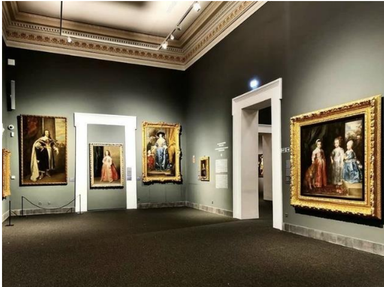
Εικόνα 209. Τεχνητός κρυφός φωτισμός στην οροφή αίθουσας και τεχνητός φωτισμός αντικειμένων και πινάκων πιθανώς με φωτισμό LED και με την τεχνική small και middle angle στο Palazzo Reale.
