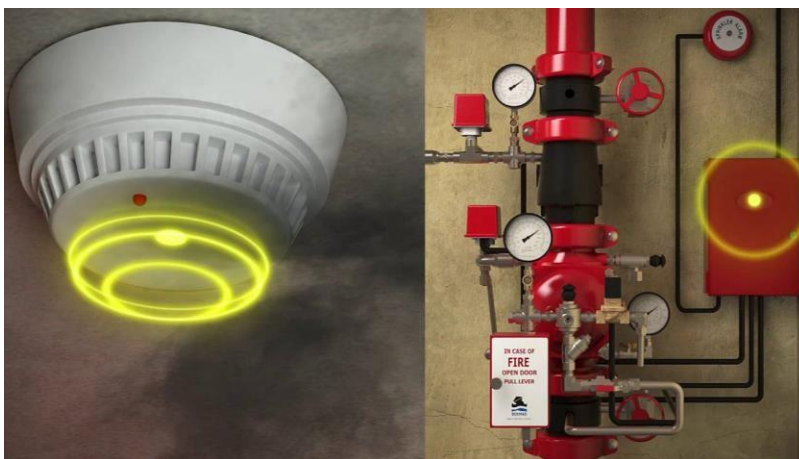
Εικόνα 101. Pre action Sprinkler System.
