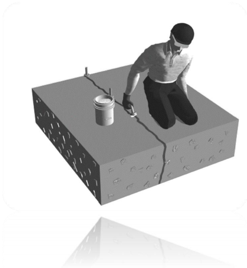
Εικόνα 3.6: Τοποθετούνται επιστόμια στις θέσεις όπου έχουν ανοιχτεί οι οπές.
