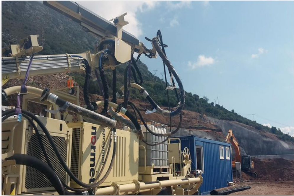
Εικόνα 2.13: Ειδικό μηχάνημα εκτόξευσης σκυροδέματος NORMET SPRAYMEC 7110 WPC
