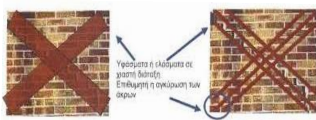
Εικόνα 6.16: Ενίσχυση τοιχοποιίας με χιαστή διάταξη από ανθρακούφάσματα και ανθρακοελάσματα.
