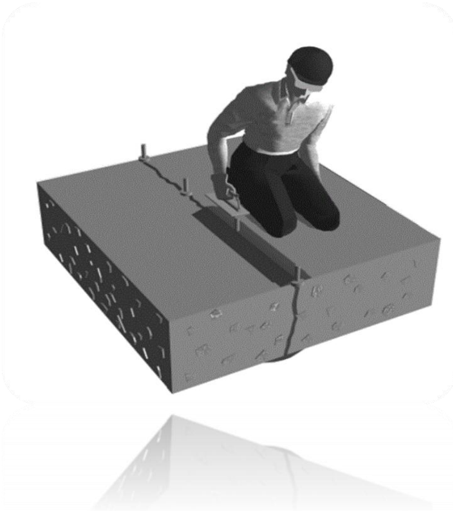
Εικόνα 3.7: Επιφανειακή σφράγιση της ρωγμής με εποξική, η οποία εγχύνεται υπό πίεση στη ρωγμή.
