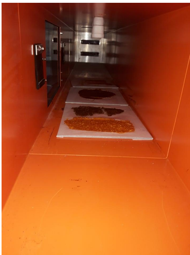
Εικόνα 5 Εικόνα εντός του εργαστηριακού ξηραντήρα Armfild κατά την διάρκεια ξήρανσης δειγμάτων
