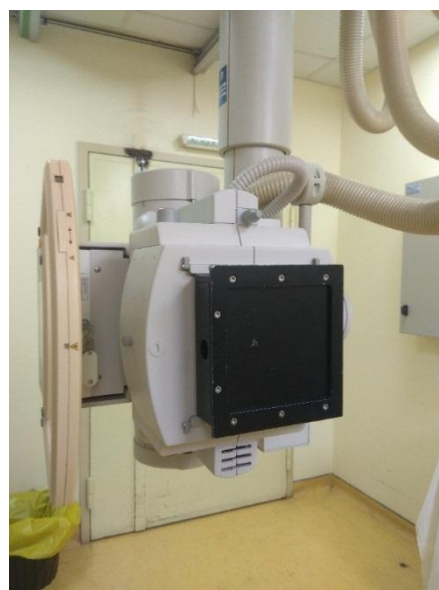
Εικόνα 8.7. Τοποθέτηση φύλλου Αλουμινίου στην λυχνία ακτινοβολήσης
