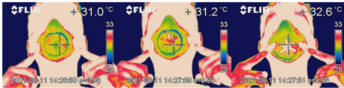
Εικόνα 2.3.2.4: Θερμική απεικόνιση μάσκας προσώπου με φίλτρο ενεργού άνθρακα (αναπνοή, ομιλία, έντονη εμφύσηση) (Πηγή: Πανεπιστήμιο Δυτικής Αττικής)
