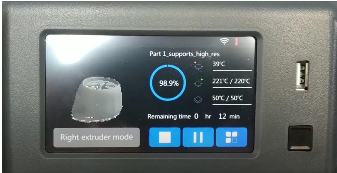
Εικόνα 2.2.3.3: Ενδείξεις από την οθόνη του εκτυπωτή σε πραγματικό χρόνο (Πηγή: Πανεπιστήμιο Δυτικής Αττικής)
