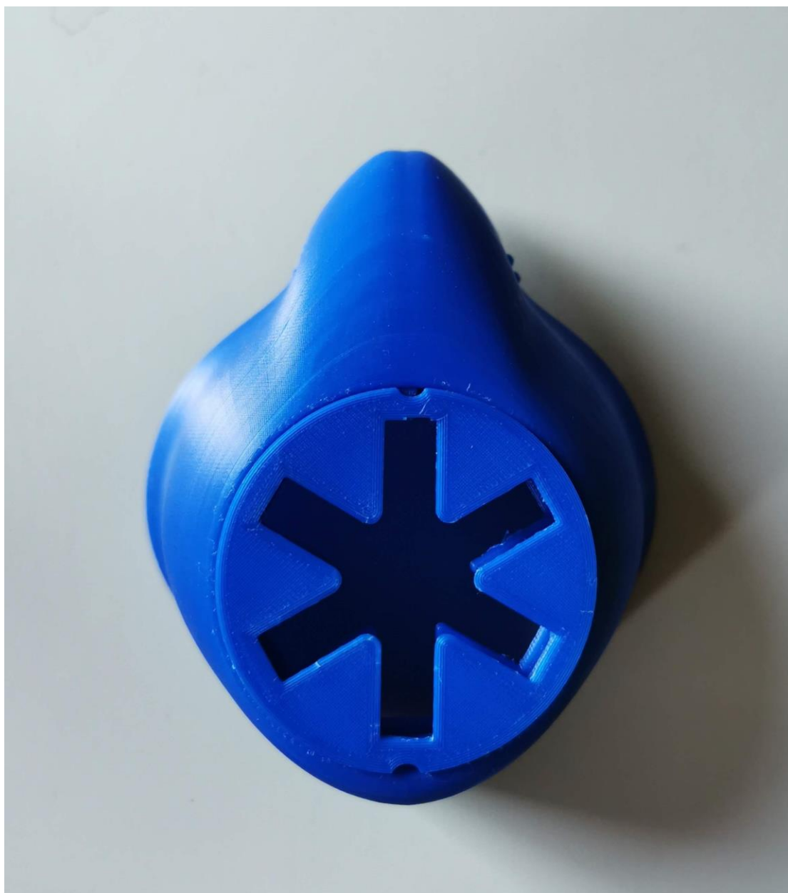
Εικόνα 2.2.3.9: Τελικό αποτέλεσμα εκτύπωσης μάσκας προσώπου με εφαρμοσμένο κάλυμμα φίλτρου (άνω όψη)
