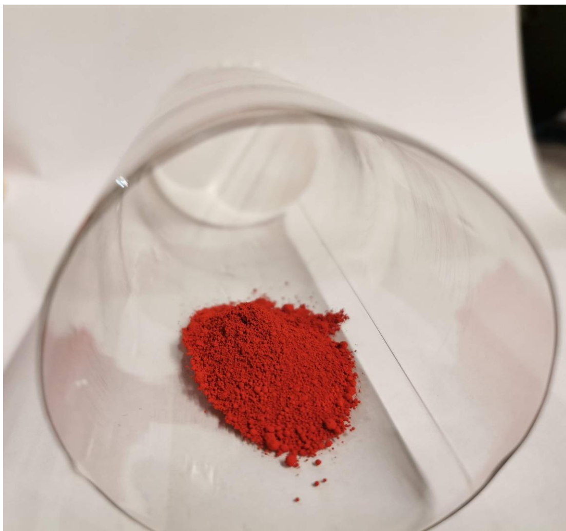
Εικόνα 2.3.1.2: Τοποθέτηση σκόνης toner εντός του γυάλινου σωλήνα (εσωτερική όψη)
