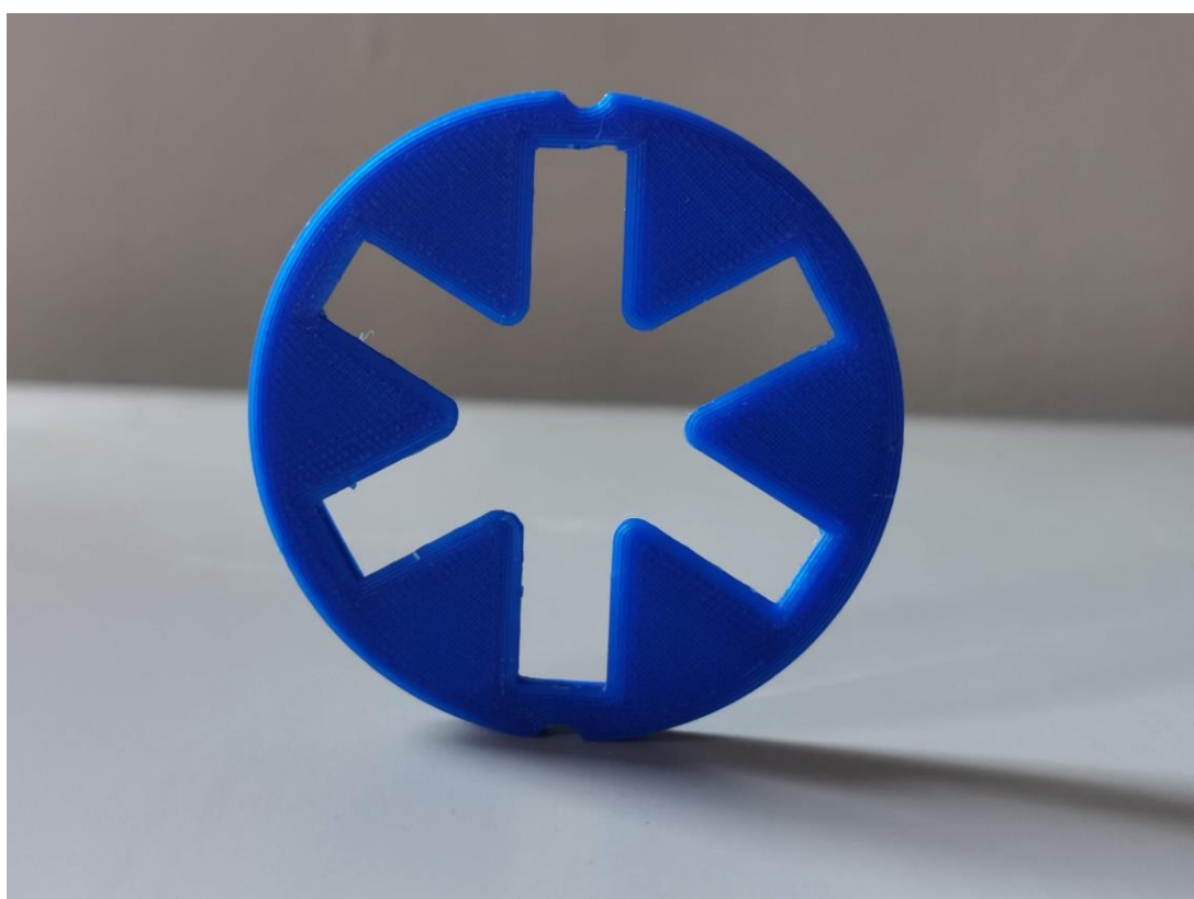
Εικόνα 2.2.3.7: Τελικό αποτέλεσμα εκτύπωσης καλύμματος φίλτρου μάσκας προσώπου (άνω όψη)
