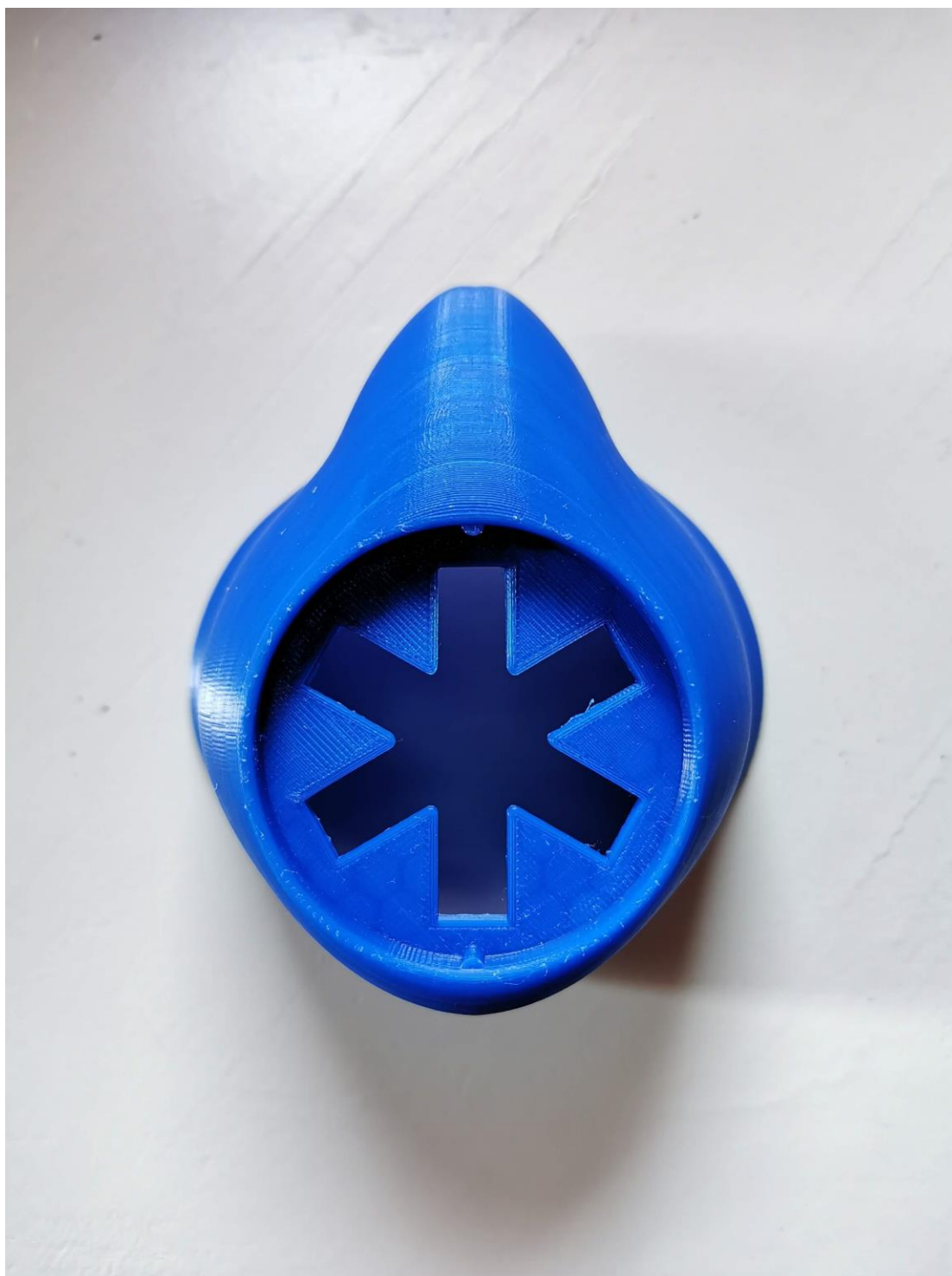
Εικόνα 2.2.3.5: Τελικό αποτέλεσμα εκτύπωσης σώματος μάσκας προσώπου (άνω όψη) (Πηγή: Πανεπιστήμιο Δυτικής Αττικής)
