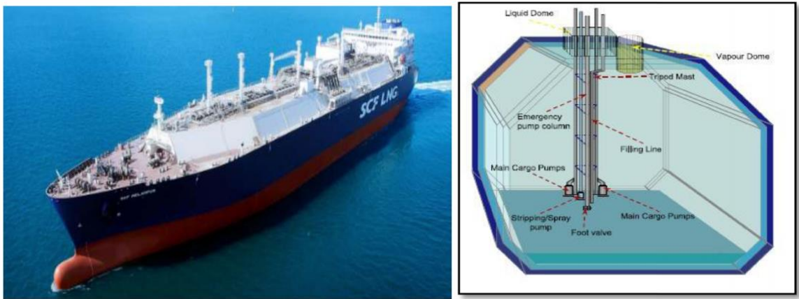
Εικόνα 5: Δεξαμενή τύπου μεμβράνης
