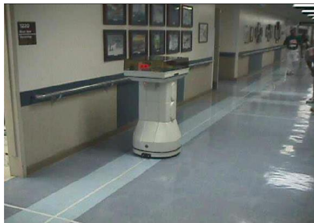
Εικόνα 1.8 Νοσοκομειακό ρομπότ ακολουθεί μαγνητικό πεδίο ( πηγή )
