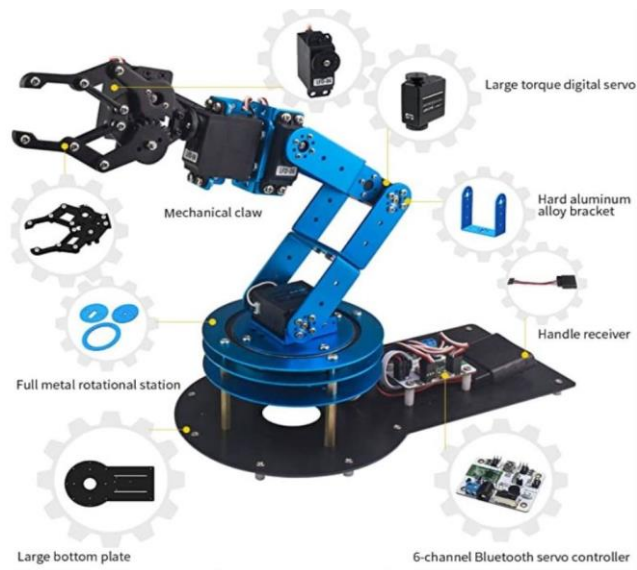
Εικόνα 2.4 : Βασικά μέρη του ρομποτικού βραχίονα (πηγή)
