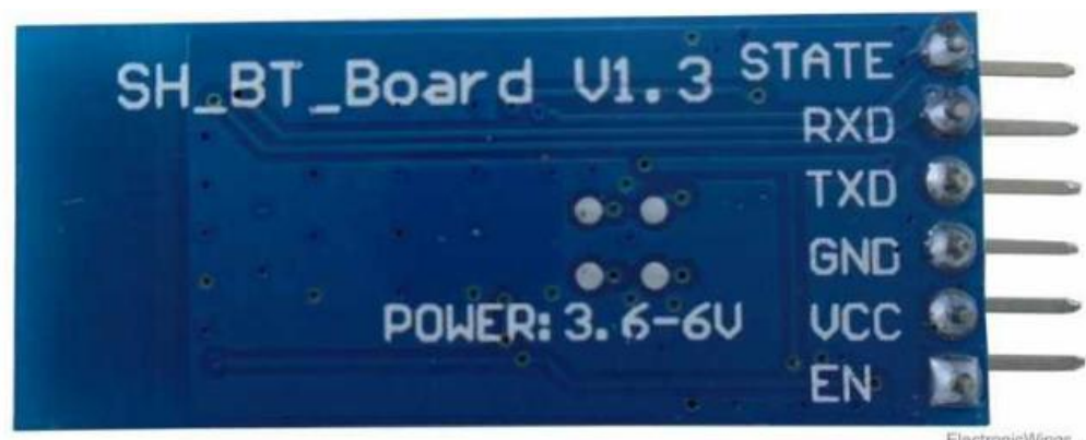
Εικόνα 2-14. Ακροδέκτες του αισθητήρα[36].
