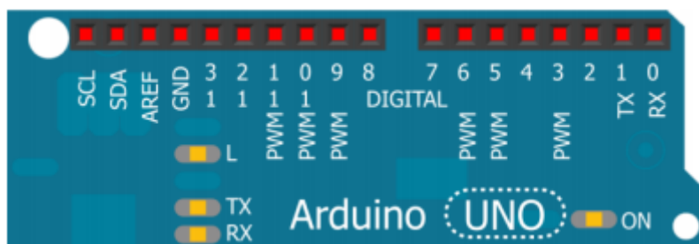
Εικόνα 2-5. Ψηφιακοί ακροδέκτες του Arduino[29].
