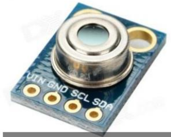
Εικόνα 2-16. Αισθητήρας θερμοκρασίας MLX90614[38].
