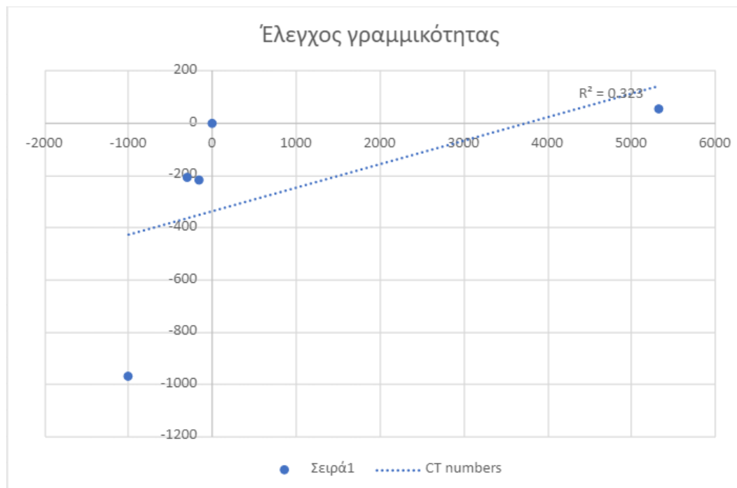
Εικόνα 9.3: Έλεγχος γραμμικότητας αριθμών υπολογιστικής τομογραφίας για τα 80 kVp.
