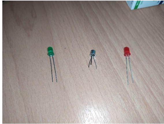
Εικόνα 5.15: Φωτογραφία με φωτάκια τύπου LED και τρανζίστορ PnP.
