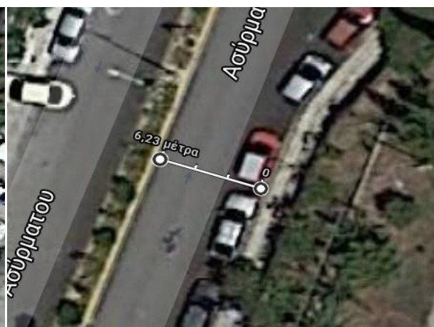
Εικόνα 8.12 Υπολογισμός πλάτους οδού Ασυρμάτου ανάμεσα σε οδούς Κουντουριώτου και Ελπίδος (6,2 μέτρα) [Ιστ.81]
