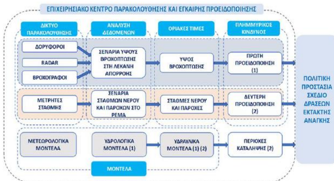
Εικόνα 7: Απεικόνιση ενός ενδεικτικού συστήματος έγκαιρης προειδοποίησης πλημμύρας [12]
