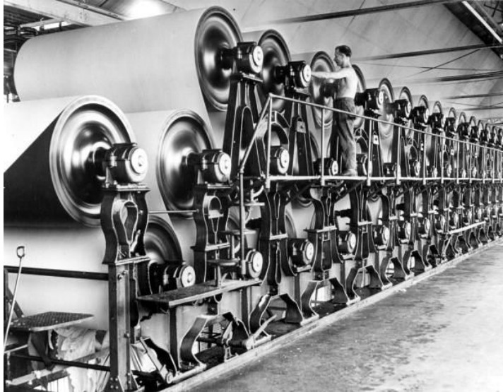
Εικόνα 40. Κύλινδροι ξήρανσης χαρτιού σε χαρτοποιητική μηχανή (1970).
