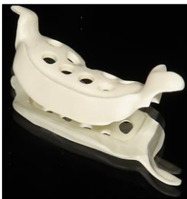
Εικόνα 4-10 Σκελετός που κόπηκε από δίσκο Ce-TZP/A. 23
