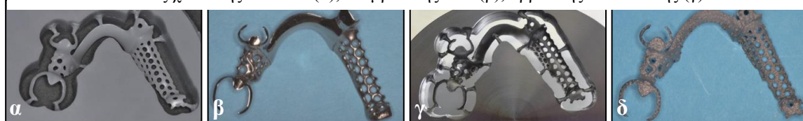
Εικόνα 4-7 Πρότυπο σκελετού Ti Μ.Ο. μετά την I-MIL (α, β). Σκελετός Ti από H-MIL (γ). Σκελετός μετά από πυροσυσσωμάτωση με λέιζερ όπου διακρίνεται το πρόβλημα της τραχείας επιφάνειας που δημιουργείται (δ). 35
