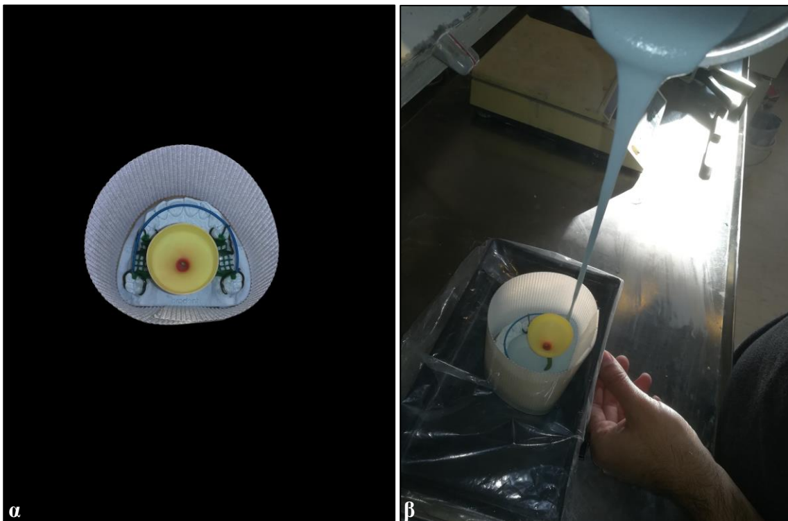
Εικόνα 13-13 Τοποθέτηση εκμαγείου στο δακτύλιο χύτευσης (α), επένδυση με πυρόχωμα (β) και στη συνέχεια χύτευση κατά τα γνωστά (αποκήρωση, προθέρμανση, χύτευση, ψύξη). Σημειώνεται, ότι μετά το τέλος των σταδίων της χύτευσης, μπορεί να ακολουθήσει η κατάλληλη θερμική κατεργασία του κράματος.
